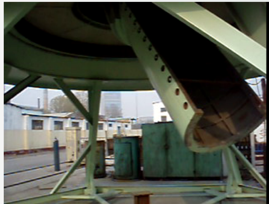
炼铁高炉的多环布料
